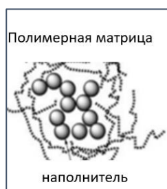
рис. 3 Структура композиционного материала с частицами наполнителем
