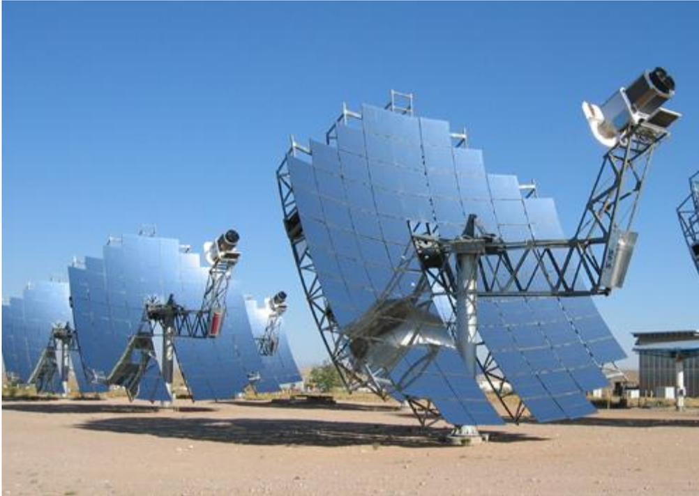
Figura 18 Disco parabólico con motor Stirling [16]
