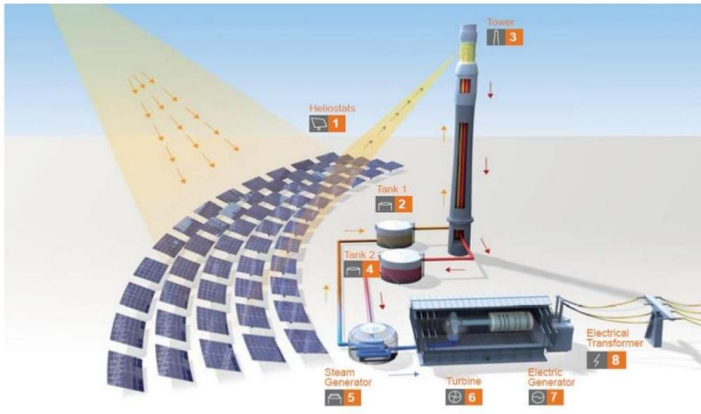
Figura 26 Gemasolar la primera planta termosolar con sales fundidas [24]
