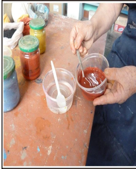
Figura 39: La autora sedimentando los pigmentos
