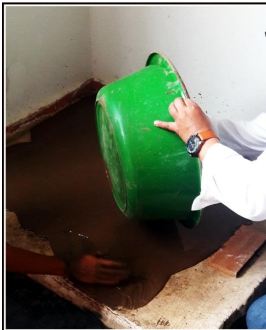
Figura 36: La autora deshidratando la arcilla
