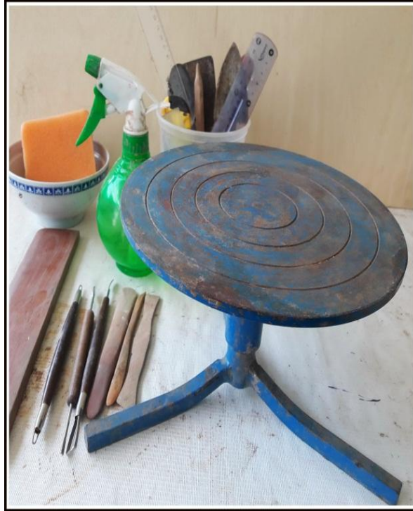
Figura 30: Torneta y herramientas de modelado
