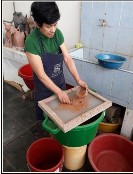
Figura 35: La autora tamizando la arcilla
