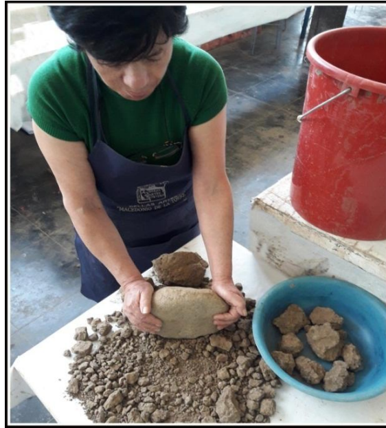
Figura 33: La autora pulverizando el material arcilloso
