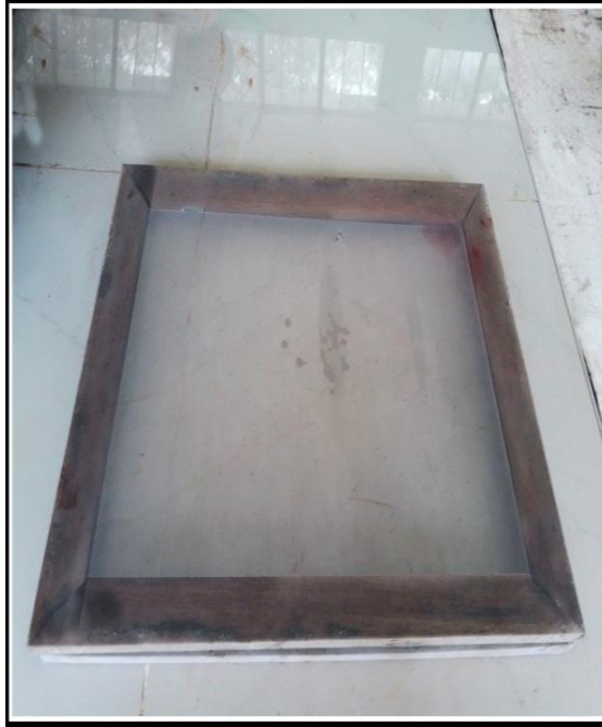
Figura 26: Bastidor con malla de grano medio
