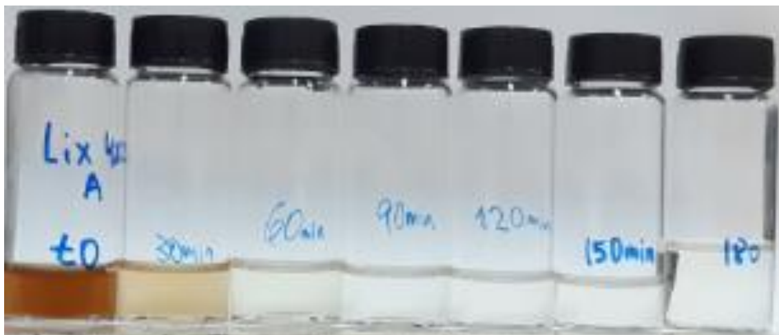
Figura 20 - Mudança de coloração na eletrocoagulação com ânodo de alumínio, 20 mA \text{cm}^{-2} de 420 \text{mg L}^{-1} de DQO de lixiviado simulado. Fonte: Autoria própria.
