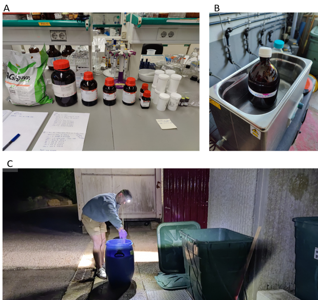
Figura 3.1: Preparación de los cócteles. A) medida de los trazadores en laboratorio. B) sonicando las microsferas antes de mezclarlas con el resto de trazadores para formar el cóctel 3. C) dilución y homogeneización de los trazadores en el volumen de agua para formar los cócteles, poco tiempo antes de la inyección.
