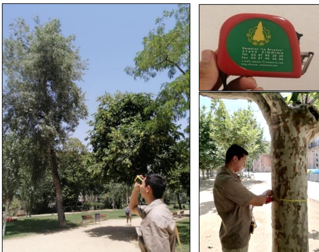
Figura 11. Equipos utilizados para las mediciones (telémetro y cinta diamétrica).
