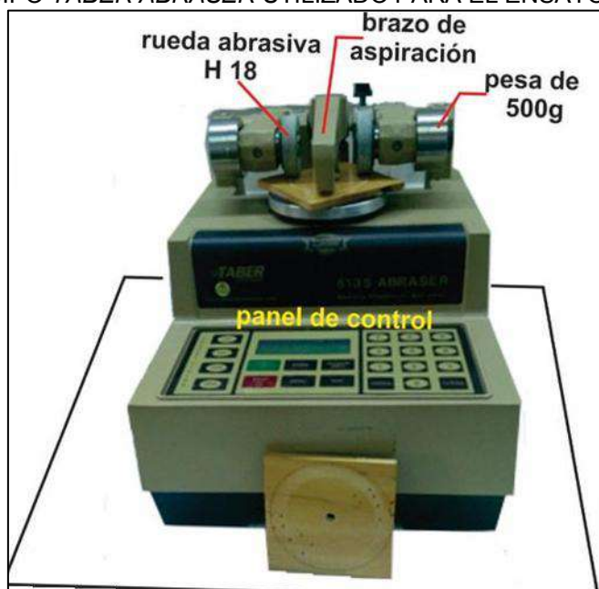
FIGURA 13 - EQUIPO TABER ABRASER UTILIZADO PARA EL ENSAYO DE ABRASIVIDAD
