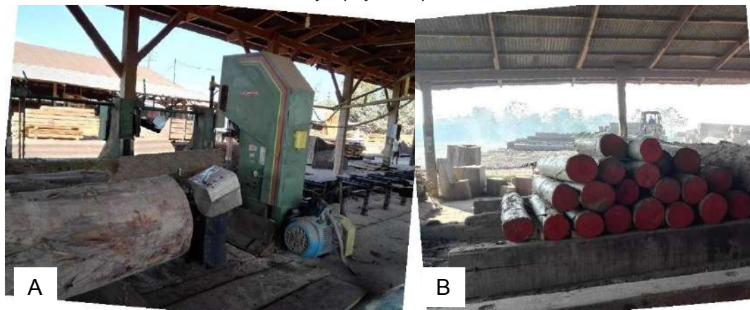
FIGURA 4 - (A): SIERRA DE CINTA VERTICAL UTILIZADA PARA LA OBTENCIÓN DE TABLAS. (B): TROZAS DE Calycophyllum spruceanum
