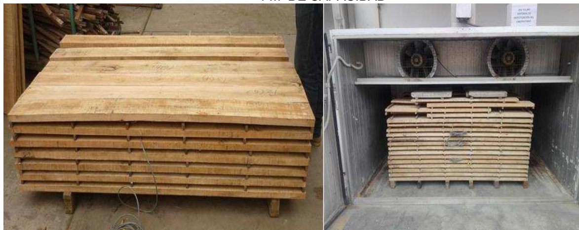
FIGURA 5 - SECADO DE LA MADERA DE Calycophyllum spruceanum EN HORNO ELÉCTRICO DE 1 m 3 DE CAPACIDAD
