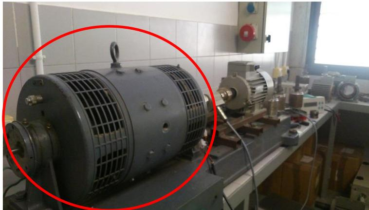
**Figura 55. Motor de Corriente Continua en configuración generador (dínamo)**
