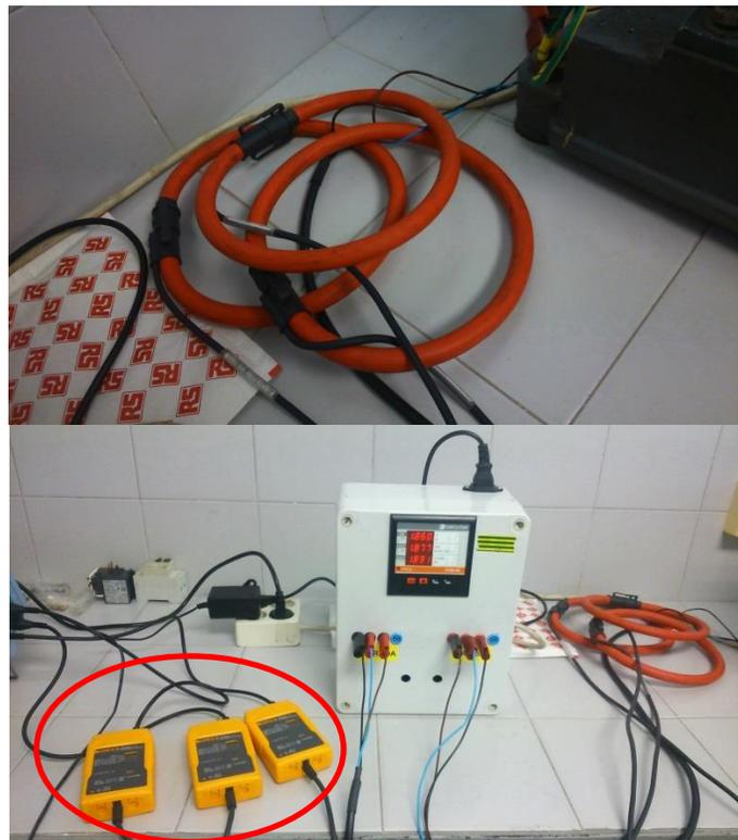
**Figura 51. Sonda de corriente (Flukei300s). Arriba: sensores de corriente en cada línea de alimentación. Abajo: acondicionadores de señal**
