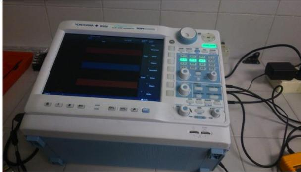
**Figura 50. Registrador de datos (ScopeCorder DL850)**
