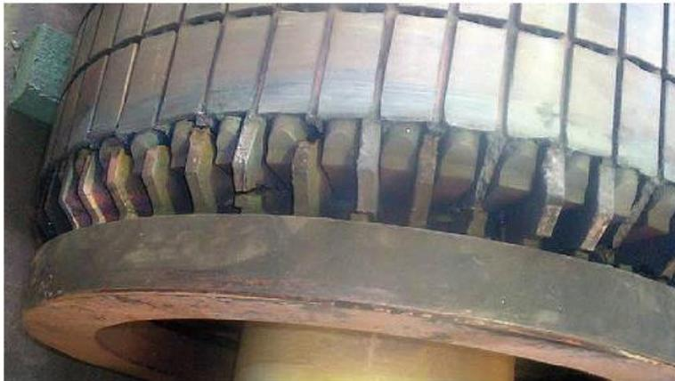
*Figura 35. Rotor de 5MW, 6kV con múltiples barras rotas*
