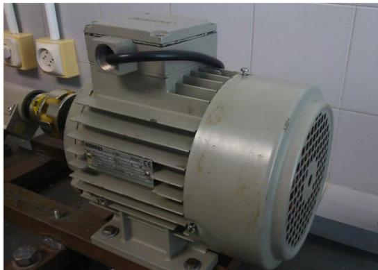
*Figura 52. Motor eléctrico de inducción*
