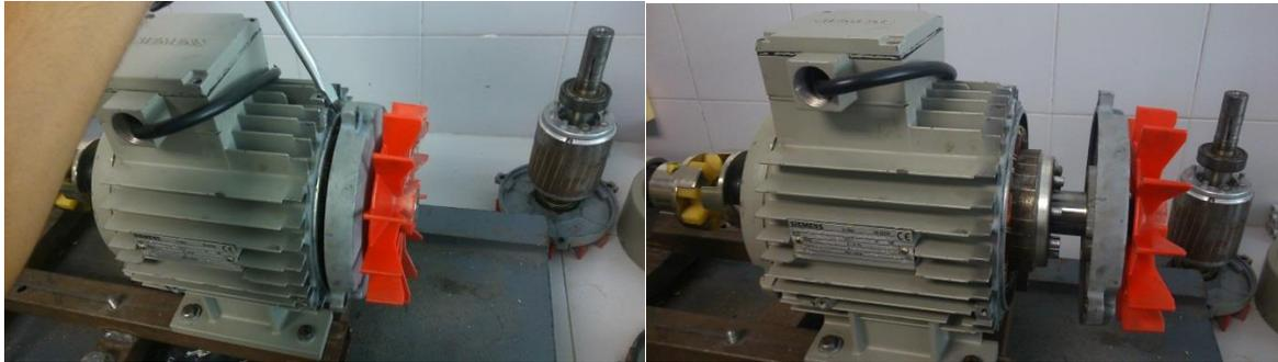
**Figura 60. Retiro del rotor**
