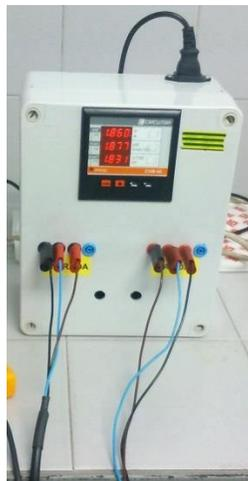
**Figura 49. Medidor de calidad de Energía**
