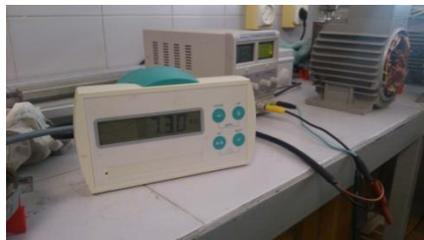
*Figura 53. Torquímetro. Arriba: Sensor. Abajo: Display*
