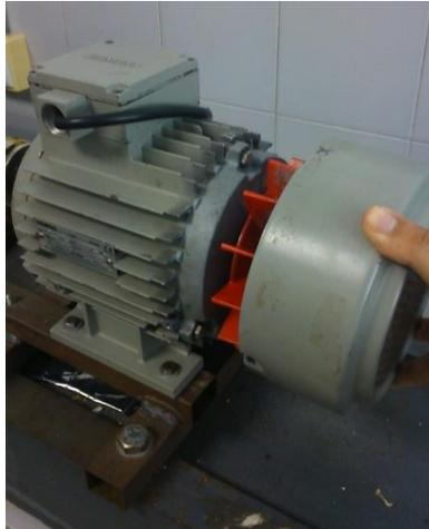
**Figura 57. Retiro de guarda de protección del motor.**
