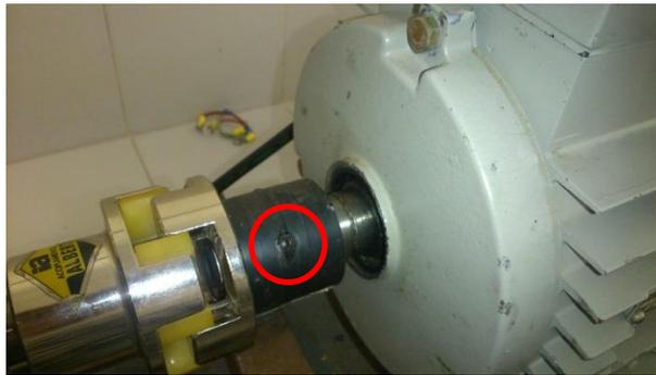
**Figura 58. Pin de sujeción del acoplamiento del eje del motor**
