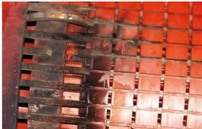
*Figura 32. Rotor con rotura de barra y daño en barras laterales*
