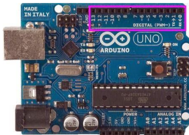
Figura 13 Bloque de Salidas Digitales y PWM Tomado de : https://www.arduino.cc/uno-bloque
