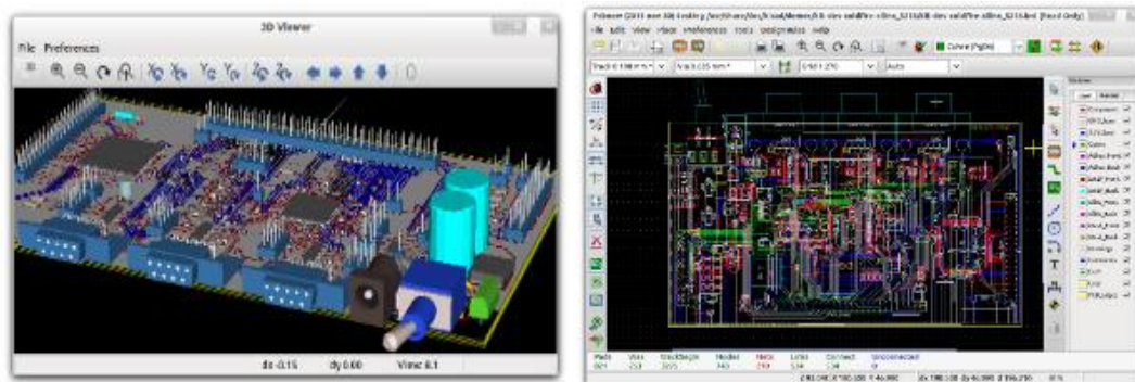
Figura 5 Diseños 3D y pcb con kicad
