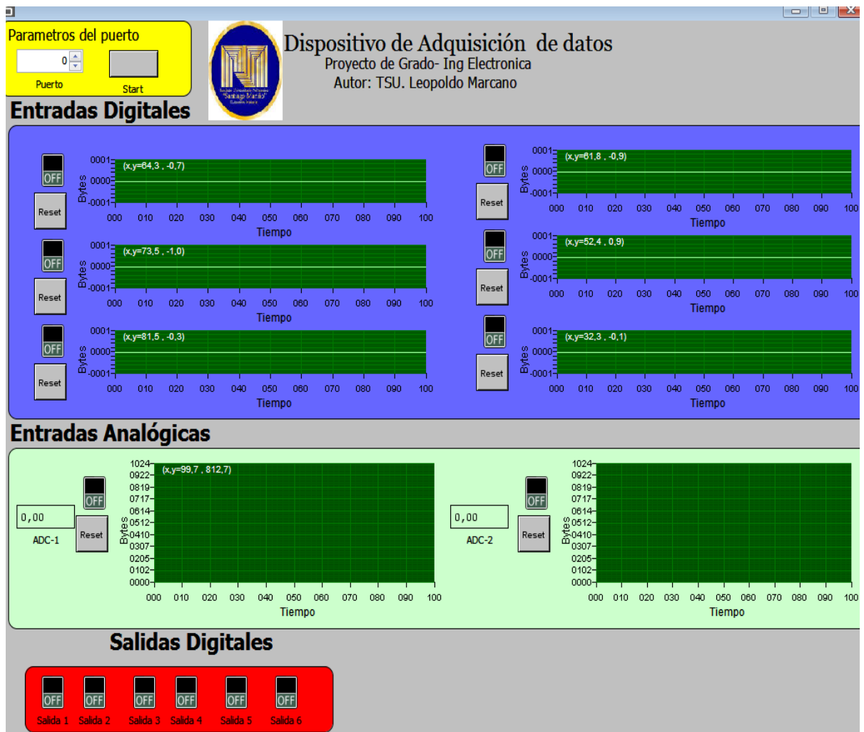
Figura 27 Interfaz Virtual del Dispositivo de Adquisición de datos. Elaborado para la interfaz Virtual con MyOpenLab
