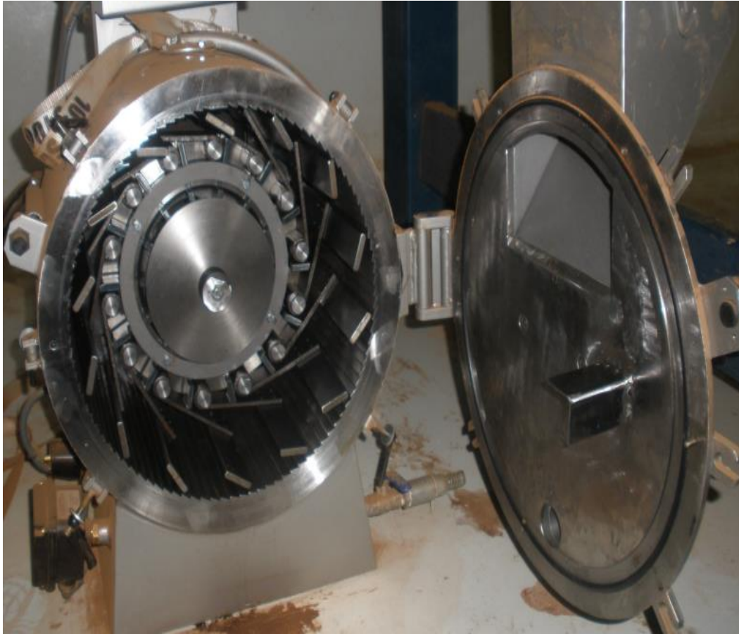
Grafico 17 “Tambor de la Máquina Refinadora MINI UNICOM UL20”
