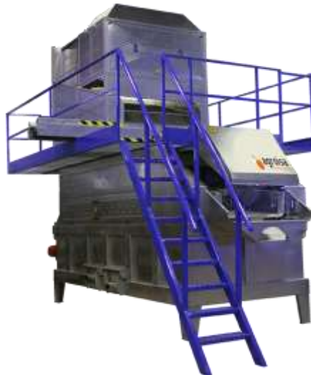
Figura 3.11 Equipo compacto de limpieza y lavado Agroisa modelo Agro STI 35 Fuente: (Catálogo AGROISA, 2019)
