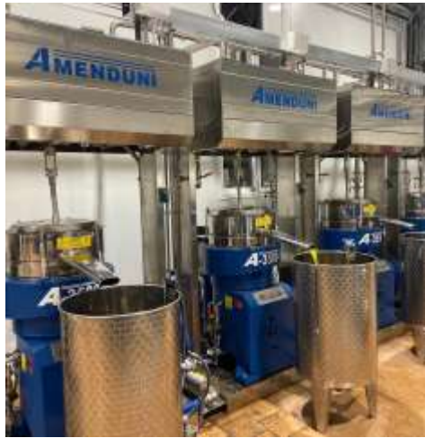
Figura 2.27 Centrifugas Verticales. Centro de Producción Santa Catalina, perteneciente a SCA Oleocampo de Torredelcampo, Jaén. (Fuente: Elaboración propia )
