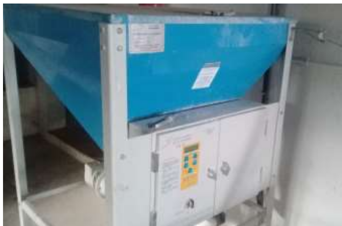
Figura 2.21 Dosificador de talco. Centro de Producción S. Bartolomé, perteneciente a SCA Oleocampo de Torredelcampo, Jaén. (Fuente: Elaboración propia )
