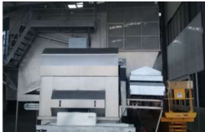
Figura 2.11 Equipo de limpieza y lavado. Centro de Producción S. Bartolomé, perteneciente a SCA Oleocampo de Torredelcampo, Jaén. (Fuente: Elaboración propia )
