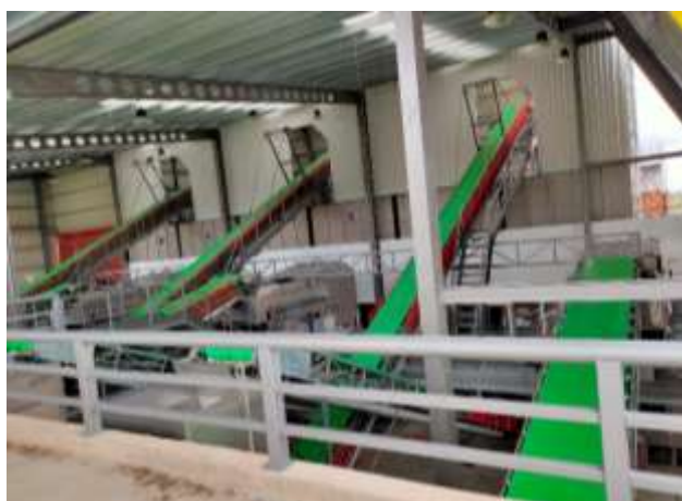
Figura 2.13 Cintas de transporte. Centro de Producción S. Bartolomé, perteneciente a SCA Oleocampo de Torredelcampo, Jaén. (Fuente: Elaboración propia )
