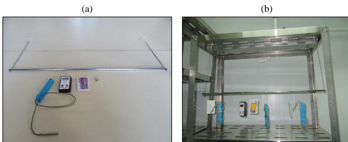
Figura 8. (a) Sensores Fijados en la barra de metal. (b) Sensores colocados en la estantería de una de las Cámaras
