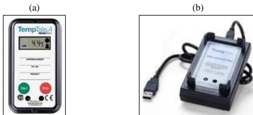
Figura 5. (a) Sensor Temptale. (b) Lector para Temptale.
