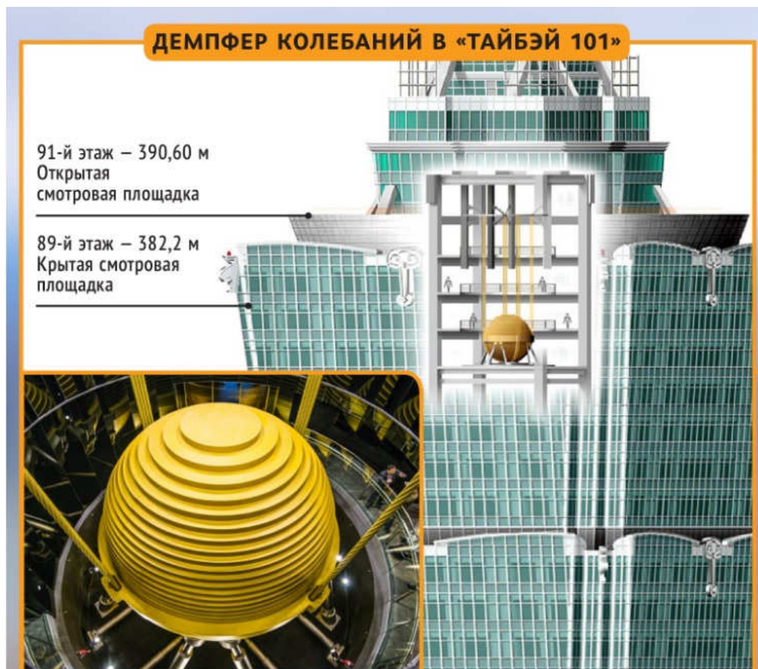
Рисунок 1.16 – Колебательный маятник здания Тайбэй 101
