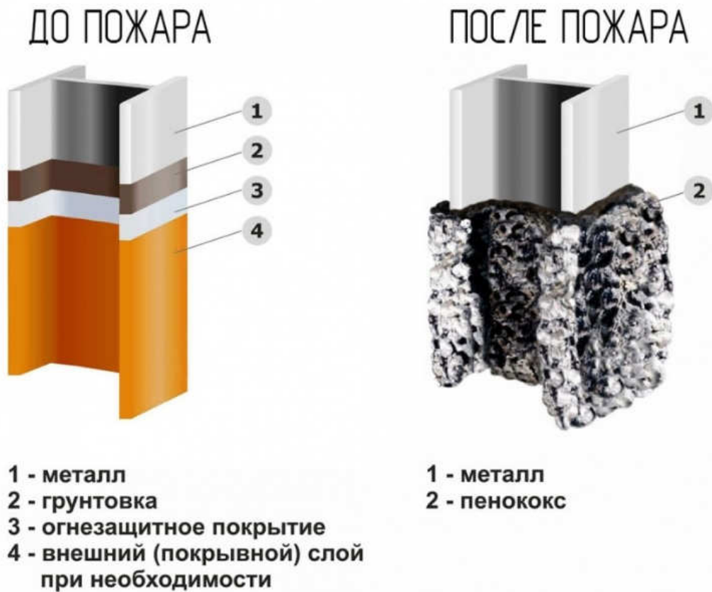
Рисунок 1.20 – Послойное нанесение состава, процесс обугливания состава
