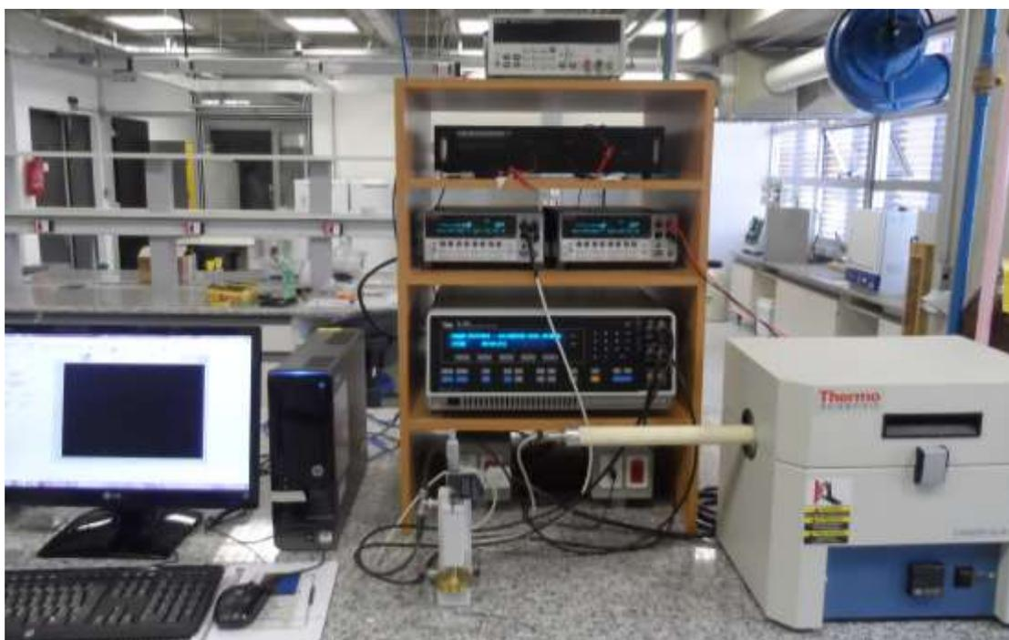
**Fig. 3.5.5** - Equipamentos utilizados para as medições de resistividade elétrica, impedância e polarização elétrica.
