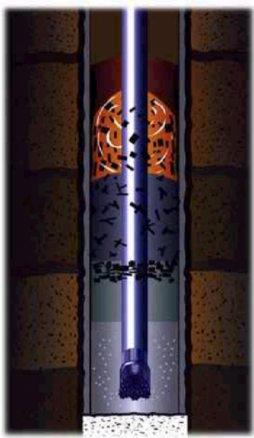
FIG. 4.1 ESQUEMA DEL MOVIMIENTO TURBULENTO DE LOS RIPIOS
