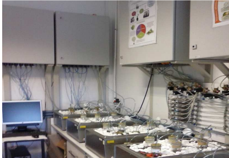
Figura 3.3 Reactores de 500 mL sumergidos en baños termostatizados y sistema de medición y de control del caudal de aire y concentración de O 2 y temperatura.
