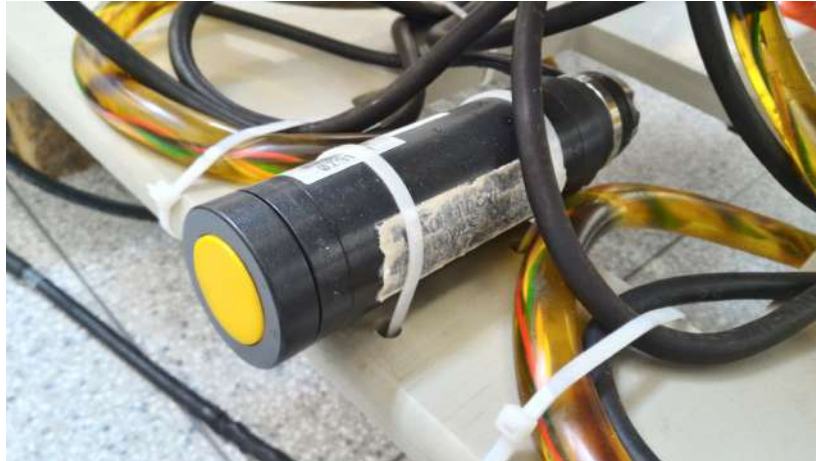
Figura 2.7: Altímetro PA500/6-PS fabricado por Tritech International Limited .
