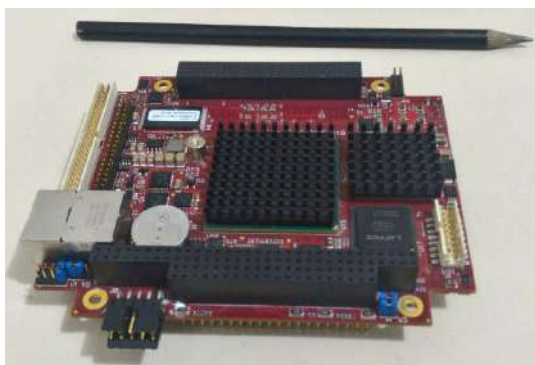
Figura 2.3: Placa Tiger fabricada por Versallogic Corporation
