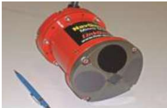
Figura 2.8: DVL NavQuest 600 fabricado por LinkQuest Inc. (Ferreira et al. , 2013)
