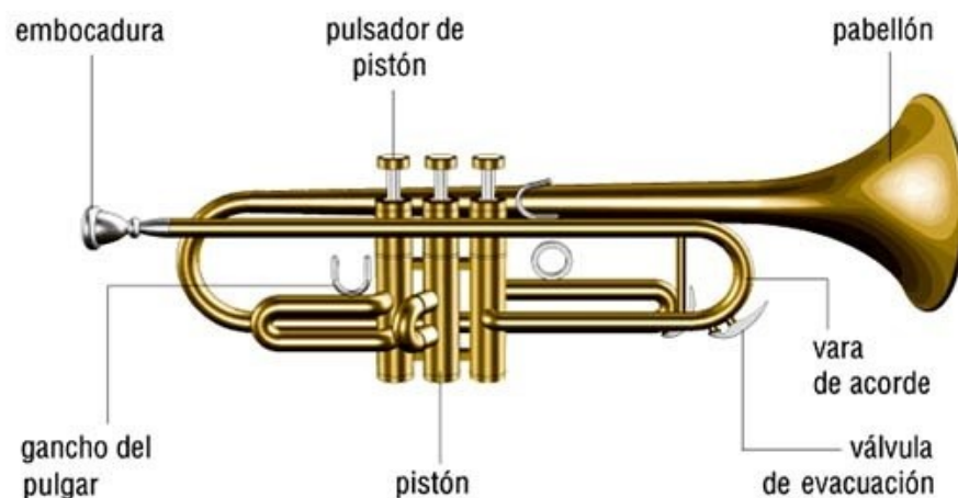
Figura N° 2.8. La trompeta y su estructura. Fuente: Sinalefa.
