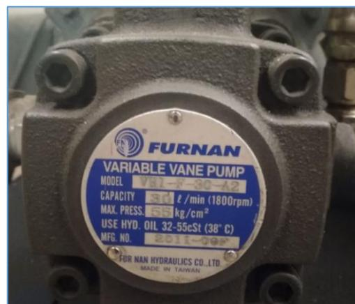
Figura 23: Placas características de motor eléctrico y bomba.
