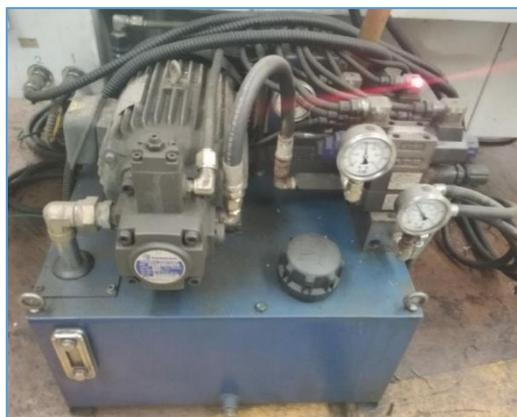
Figura 22: unidad oleohidráulica
