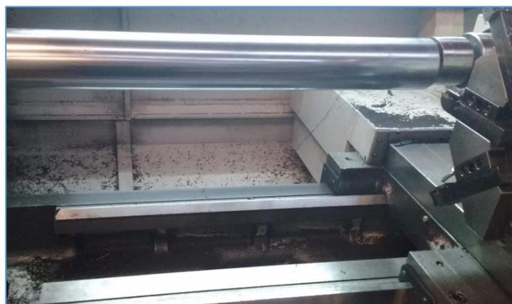
Figura 17: vista de las guías por delante del contrapunto
