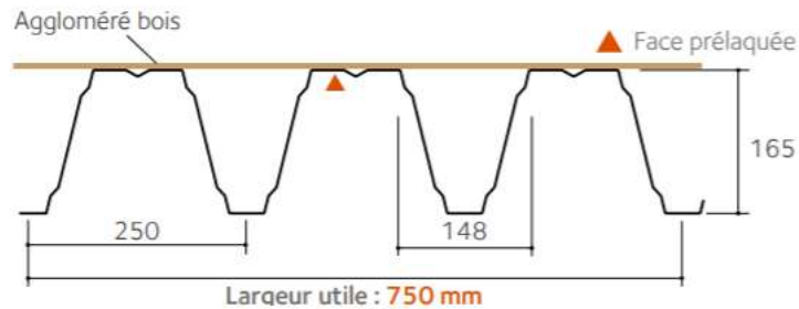
Figure 70. Vue transversale du plancher sec Supportsol 170
