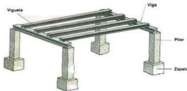
Figura 3: Componentes de un pórtico Fuente: Barros y Parra (2013)
