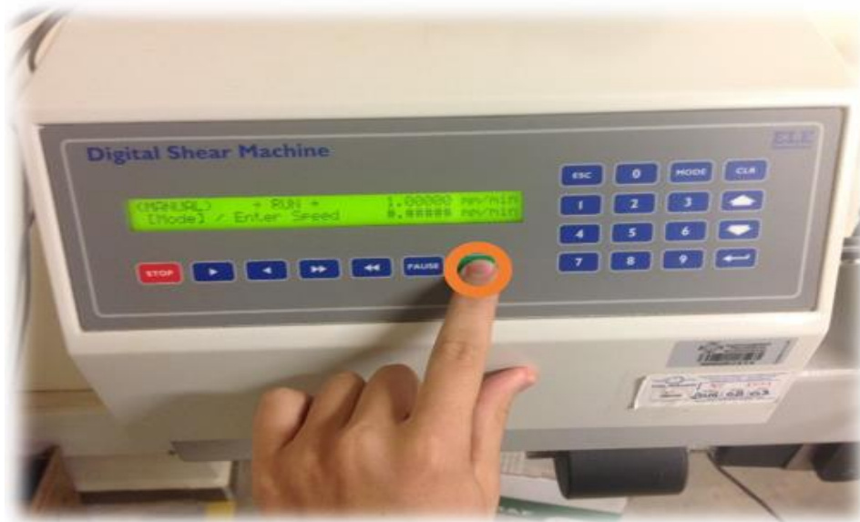
Figura 60 Inicio del ensayo de corte directo en la maquina Digital Shear Machine. Fuente: Propia
