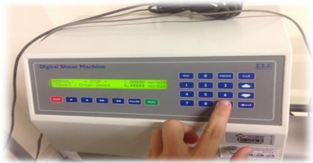
Figura 56 Registro de la velocidad de corte en la maquina Digital Shear Machine. Fuente: Propia
