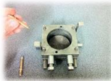
Figura 21 Restricción del movimiento de la recamara al fijar los tornillos. Fuente: Propia
