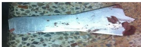
Figura 5. Ranurador Fuente: Propia
