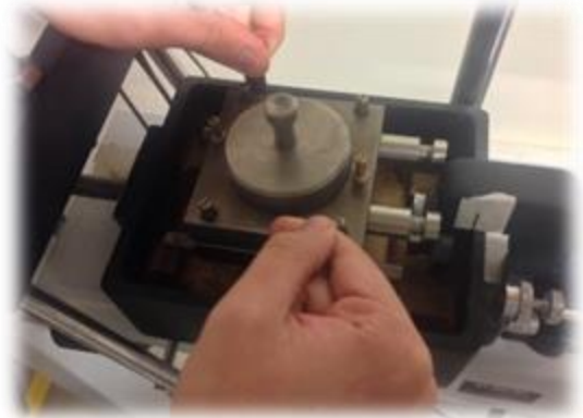
Figura 27 Disposición de la recámara en la máquina de corte. Fuente: Propia
