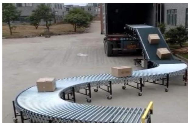
Figura 30. Cinta transportadora de camiones de carga
