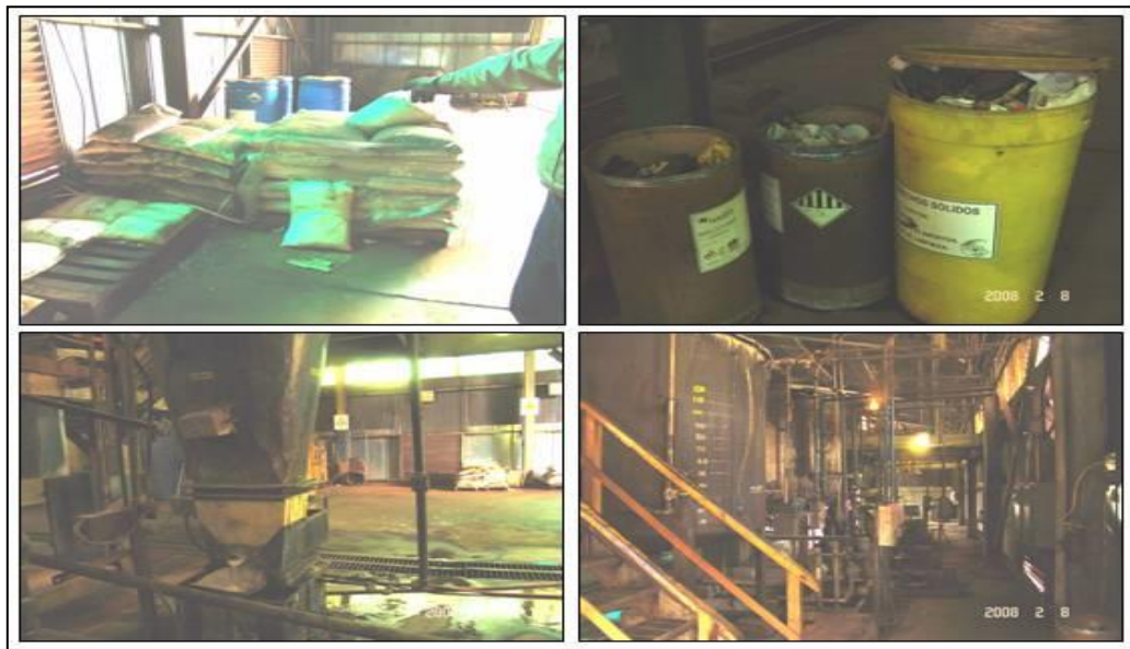
Figura 13. Superior izquierda: Reactivos y sustancias químicas; Superior derecha: Desechos sólidos de origen industrial asimilables a domésticos; Inferior izquierda: Tolva para dosificación de de químicos; Inferior derecha: Tanque de homogenización de mezcla.
