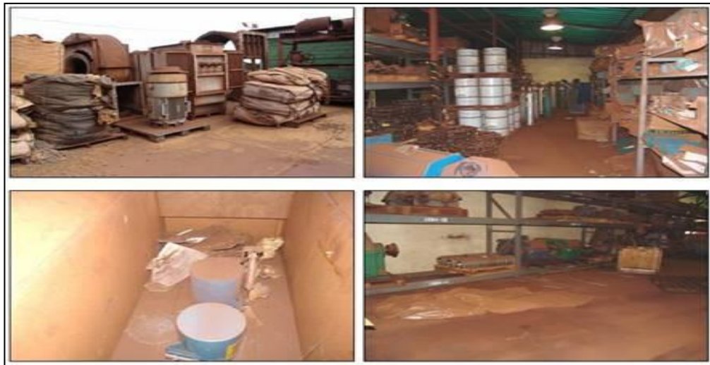
Figura 12. Superior izquierda: Reactivos químicos y transformadores contaminados con PCB; Superior derecha: Sustancias químicas y cilindros de gases comprimidos; Inferior izquierda: Fuentes de radiación Ionizante (Cs-137); Inferior derecha: Almacén
