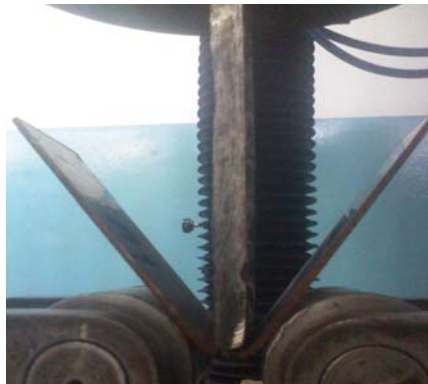
Figura 3.10. Ensayo de doblado al aire. Fuente: propia.
