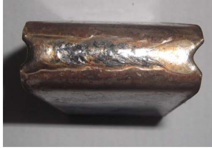
Fig. 4.23. Probeta expuesta a corrosión durante 336 horas, doblada en U.
