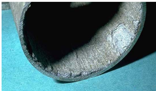
Fig. 2.12. Corrosión Intergranular. (Perry, 1998)
