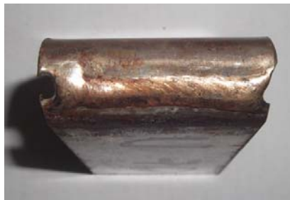
Fig. 4.22. Probeta expuesta a corrosión durante 168 horas, doblada en U.
