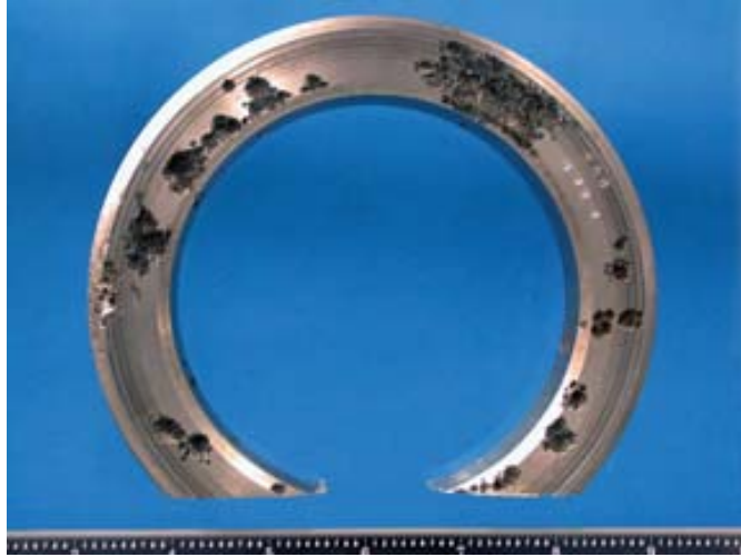
Fig. 2.11. Corrosión por picaduras. (Perry, 1998)
