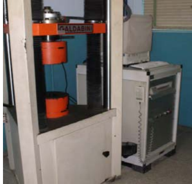
Figura 3.8. Máquina Universal de Ensayos Mecánicos utilizada. Fuente: Propia.
