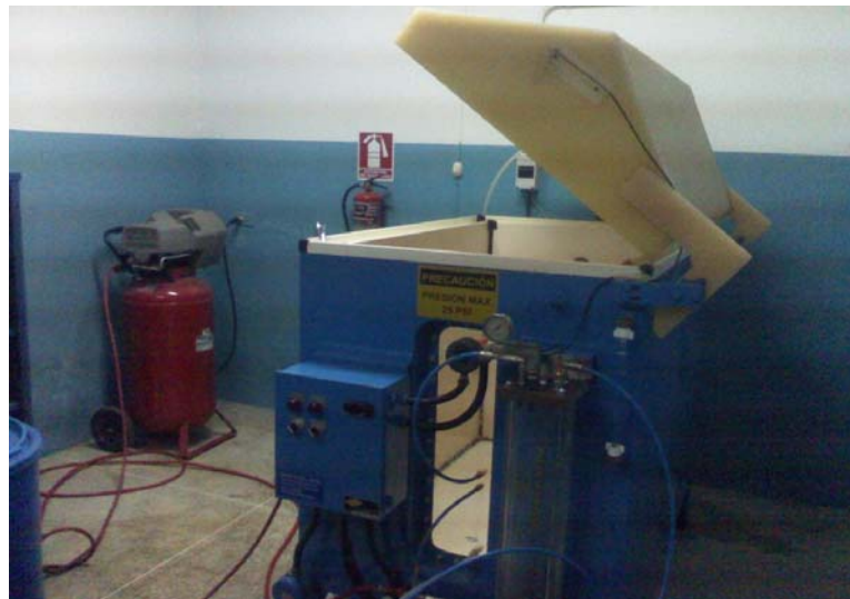
Figura 3.7. Cámara de niebla salina para ensayos de corrosión. Fuente: propia.
