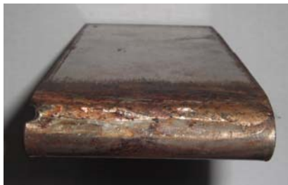
Fig. 4.21. Probeta expuesta a corrosión durante 96 horas, doblada en U.
