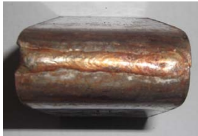
Fig. 4.20. Probeta expuesta a corrosión durante 48 horas, doblada en U.
