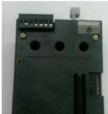
**Figura A.4. Vista de los sensores incorporados del IQ504.**
