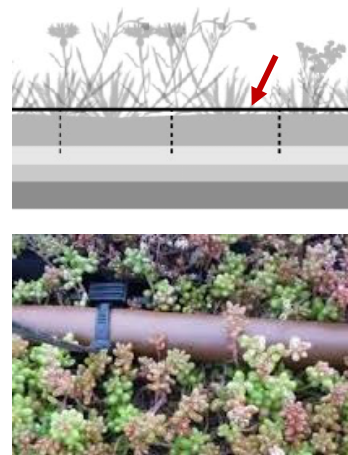
Fig. 27. Riego por goteo con mangueras sobre el sustrato. Fuente: Guía ZinCo
