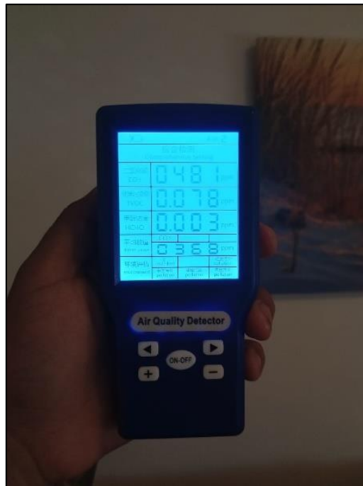
Ilustración 37 Nivel de CO2 en vivienda 1 – Datos 2
