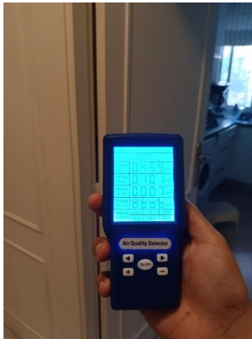
Ilustración 45 Nivel de CO2 en vivienda 2 – Datos 2
