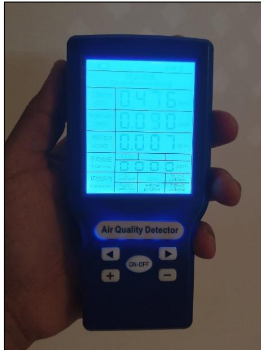
Ilustración 53 Nivel de CO2 en vivienda 3 – Datos 2
