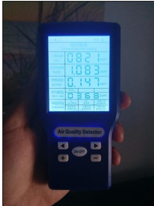
Ilustración 36 Nivel de CO2 en vivienda 1 – Datos 1
