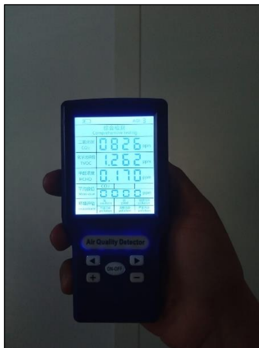
Ilustración 44 Nivel de CO2 en vivienda 2 – Datos 1
