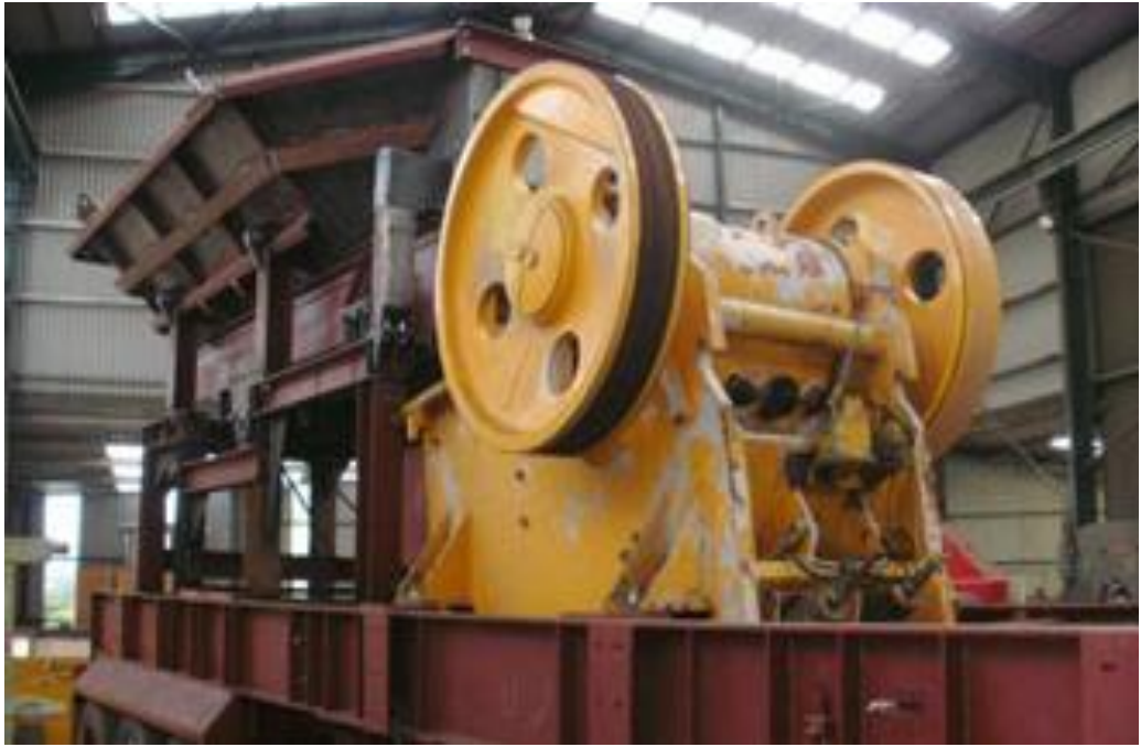
Figura 5: Moledora de material aurífero Fuente: Autoridad Nacional del Agua, 2018
