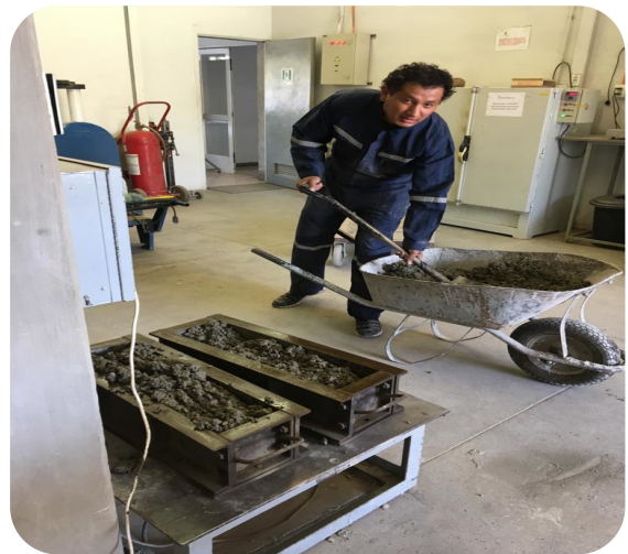
b. Preparación Vigas Prismáticas
