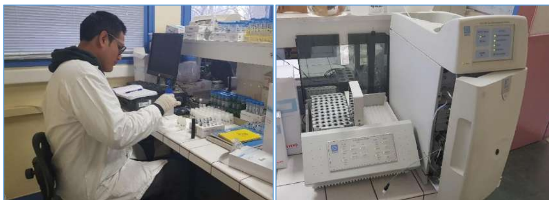
Figure 22. À gauche : Mesure des anions au laboratoire GEOPS. À droite : le chromatographe Dionex ICS-1000.
