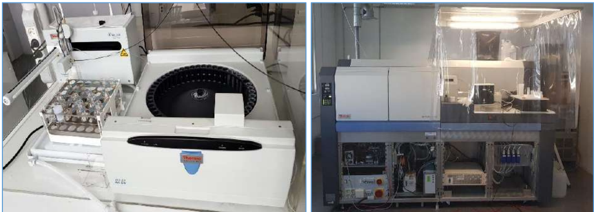
Figure 24. À gauche : Collecteur de fraction Ultimate 3000 DIONEX avec le passeur des échantillons Dionex AS DV. À droite : Neptune Plus™ High Resolution Multicollector ICP-MS.
