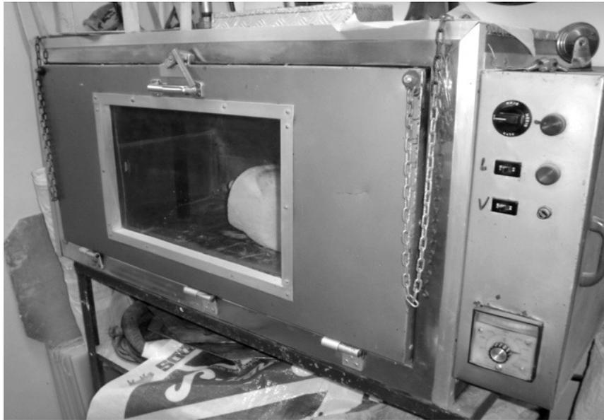
Figura 3.17.- Horno de precalentamiento
