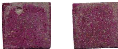
FIGURE 2.6 – Front de carbonatation de mortier avec 75 % de CO_2 pendant 2 jours
