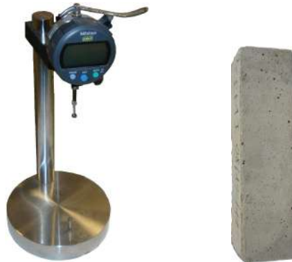
FIGURE 2.2 – Appareillage pour la mesure du retrait
