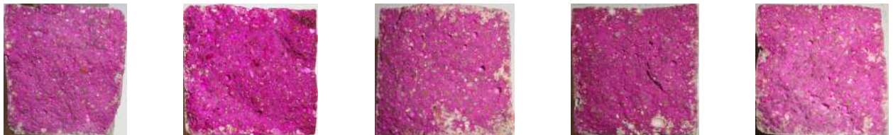
FIGURE 2.14 – Front de carbonatation de mortier avec 100 % de CO_2 pendant 1, 2, 3, 7 et 14 jours
