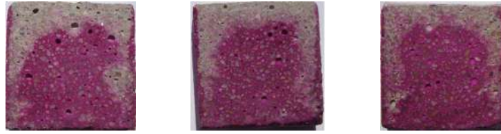
FIGURE 2.7 – Front de carbonatation de mortier avec 75 % de CO_2 pendant 14 jours
