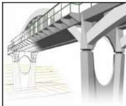
Figura 5. Puente de Viga
