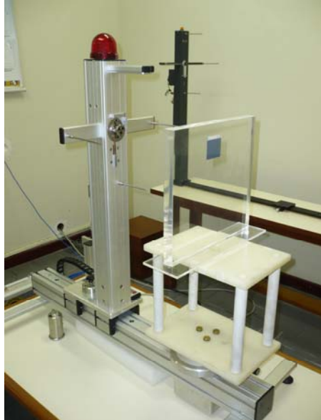
FIGURA 23. Arranjo experimental utilizado nas irradiações das amostras de filme radiocrômico com o BSS2.
