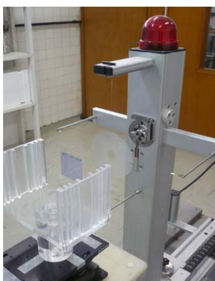
FIGURA 29. Amostra de filme radiocrômico EBT sob condições de irradiação em campos de ^{147}\text{Pm} no sistema BSS2 do LCI/IPEN.
