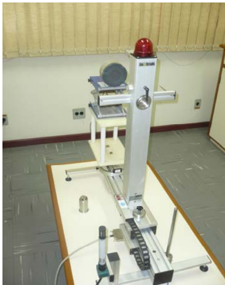
FIGURA 22. Arranjo experimental utilizado na caracterização da câmara de extrapolação PTW 23391.
