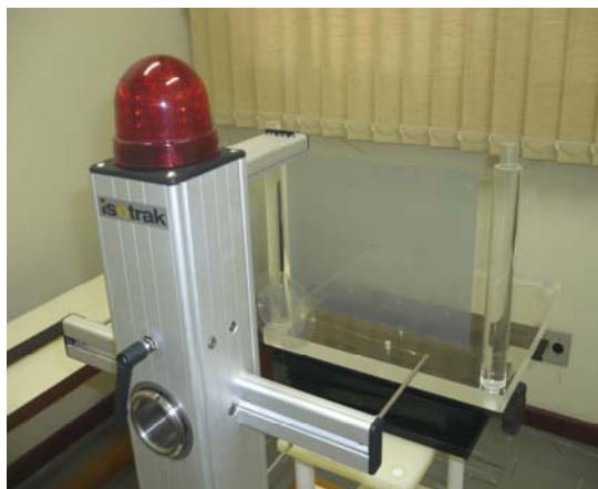
FIGURA 27. Filme radiocrômico EBT no acrílico posicionador sob condições de irradiação, no sistema BSS2 do LCD/CDTN, em campos de radiação beta ^{85}\text{Kr} .
