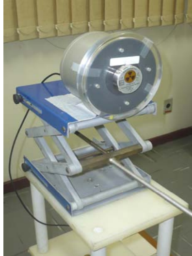
FIGURA 21. Arranjo experimental utilizado nos testes de corrente de fuga, repetitividade e reprodutibilidade da resposta da câmara de extrapolação PTW 23391.
