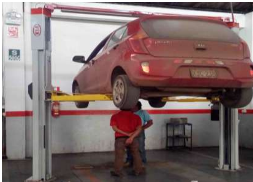
Fotografía 09, Izaje vehicular con grúa realizado cotidianamente.
