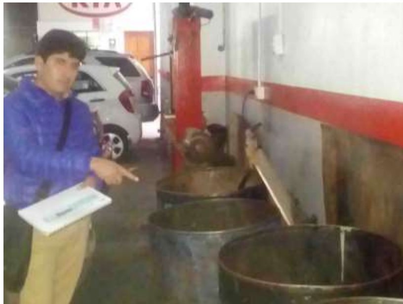
Fotografía 11, Ausencia de señalización en recipiente de residuos.
