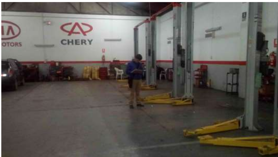
Fotografía 14, Desorden, impedimento acceso a extintor.
