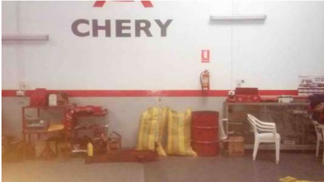
Fotografía 14, Desorden, impedimento acceso a extintor.
