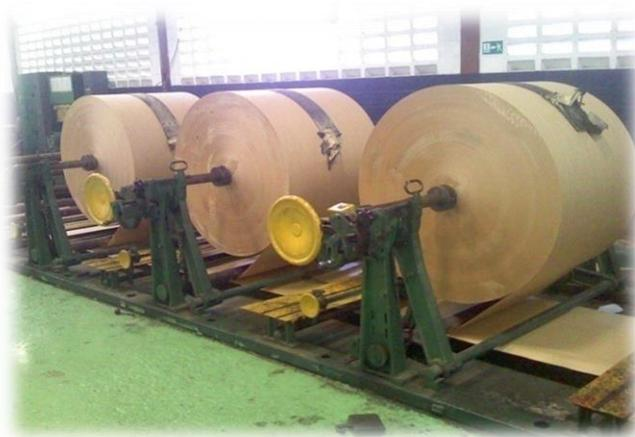
Vista de las bobinas con el eje debobinador
