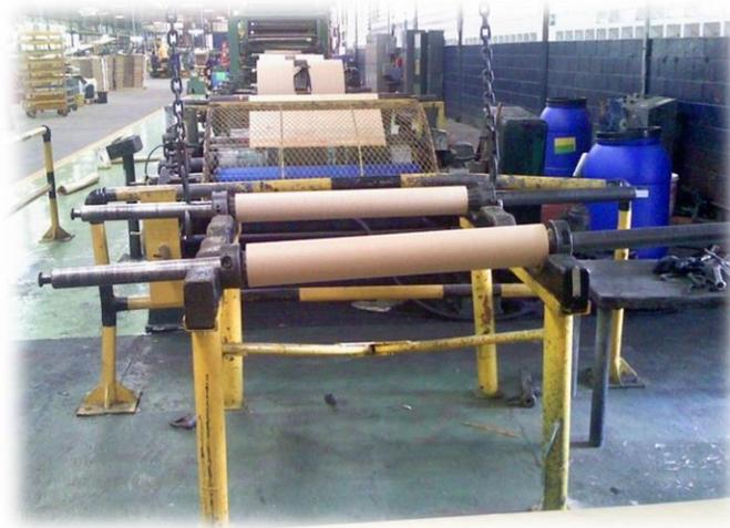
Eje debobinador con el core
