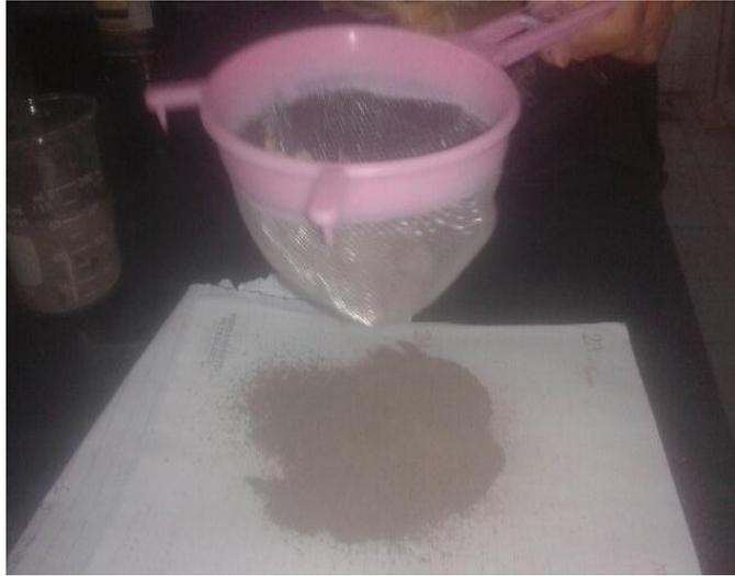
**Figura D.1 Tamizado de muestra de suelo antes de contaminar.**
