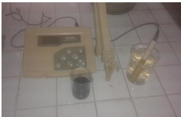
**Figura D.8 Determinación de la conductividad Eléctrica (CE) por el Método del Conductímetro.**
