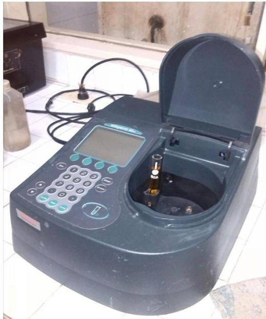
**Figura D.2 Spectronic, para cálculo de concentraciones de absorbancia y transmitancia.**
