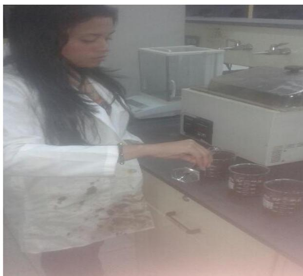
**Figura D.6 Tamizado de muestras de suelo después de contaminar y adicionando lixiviado de compost.**
