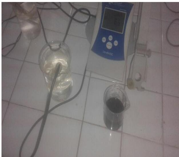
**Figura D.7 Determinación del pH por el Método del Potenciómetro**
