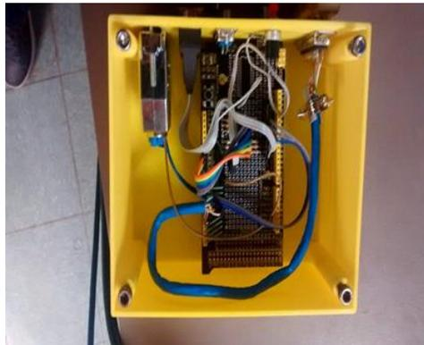
Fig.3.12 Tarjeta del microcontrolador Arduino.
