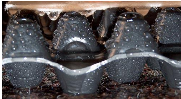
Fig. N°2.6 Membrana de drenaje en funcionamiento. Nota. Tomada de el portal de una compañía de construcción de techos verdes http://www.zincocubiertas-ecologicas.es/conceptos_basicos/manera_de_funcionar.php 12
