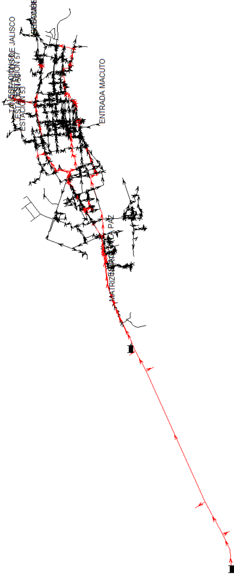
FIGURA 4.63. ESQUEMA DE ALIMENTADORES A CONSTRUIR Y SUSTITUIR COMO MEJORA DE LA RED DE DISTRIBUCIÓN DE BARQUISIMETO EN EL PERÍODO 2021 - 2030. ALTERNATIVA 1
