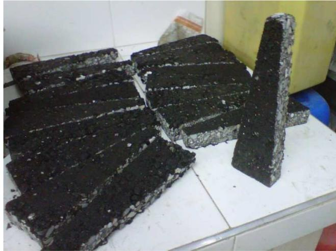
**Figura 24. Delimitación de las panelas para ensayo de Fatiga Trapezoidal.**
