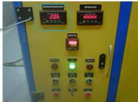
**Figura 30. Presión para envejecimiento a largo plazo empleando el equipo PAV.**
