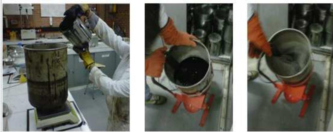
2. Posteriormente se vacía la mezcla en el molde de compactación para fatiga y para ahuellamiento.
