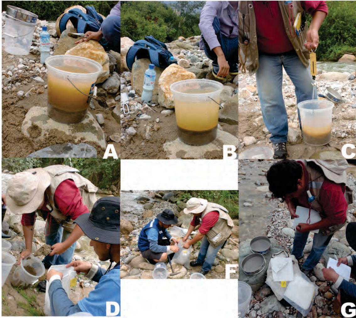
Figura 52 Proceso de toma de muestra II. A) Luego del tamizado de la muestra en malla # 30 se procede a decantar la muestra con floculante basado en sulfato de aluminio. B) proceso de decantación de los materiales finos de la muestra de los sedimentos por medio del floculante. El tiempo estimado de decantación es de unos 5 a 10 minutos. C) Extracción de agua y posterior pesado de la muestra en húmedo. D) Extracción de los sedimentos de quebrada siguiendo el protocolo de muestreo establecido. E) Sellado y etiquetado de la bolsa microporosa de muestreo, la cual es envuelta nuevamente con una bolsa de polietileno para su traslado a campamento base. F) Limpieza de los materiales usados según protocolo establecido y toma de los últimos datos de campo.
