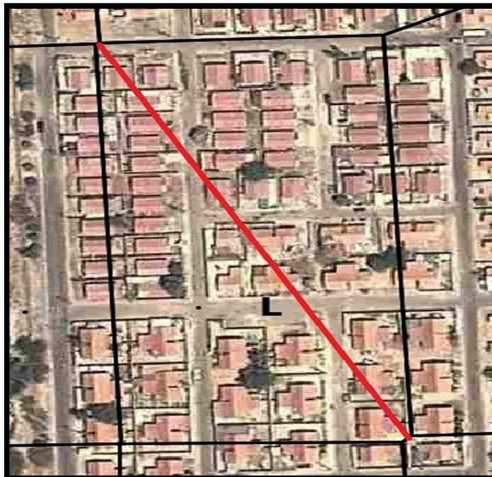
**Ilustración III.2** Estimación de la longitud entre vértices para cada subcuenca.
