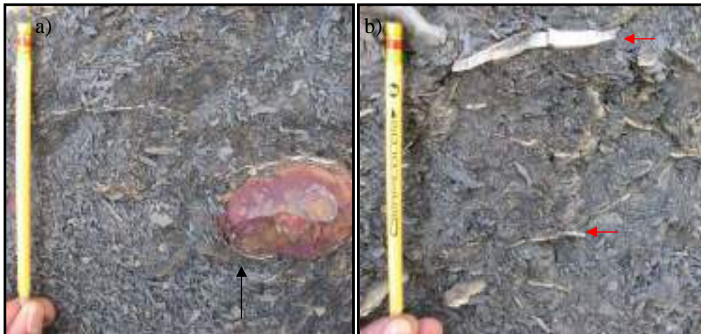
Fig. 4.21. Facies L. a) Nótese el nódulo de material ferroso oxidados (flecha negra). b) Detalle la presencia de vetas de yeso dentro de la lutita (flecha rojas).
