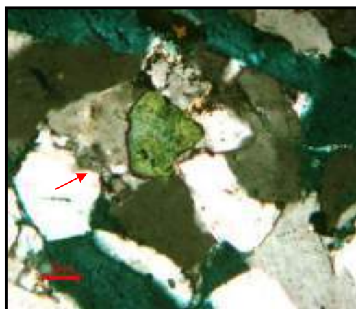
Fig. 4.71. Microfotografía de las facies S1. Cemento de cuarzo microcristalino rellenado poros (flecha roja) Obj.10x. Nícoles cruzados
