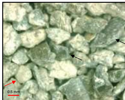
Fig. 4.100. Descripción litológica de la Formación Carapita, Campo Chaguaramal. Nótese las lutitas masivas lustrosas de color negro (flecha negras) y la aparición de limolitas en trazas (flecha roja). Prof. 14490'-14495', tamiz 40, lupa binocular (Obj. 0.75)
