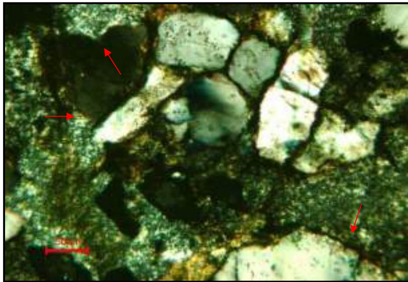
Fig. 4.38. Microfotografía de la Facies S2g. Nótese los contactos longitudinales y concavo/convexos entre los granos (flechas rojas). Obj. 10x. Nícoles cruzados
