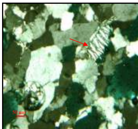
Fig. 4.84. Microfotografía de las facies S1. Porosidad por disolución del posible grano de feldespato (flecha roja). Obj.5x. Nícoles cruzados
