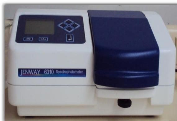
**Figura 7:** Espectrofotómetro Jenway 6310.
