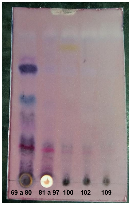
Fig. 24. Placa en fase normal de F-69 a 80, F-81 a 97, F-100, F-102 y F-109. Eluída con Chl, revelada con PAS y fotografiada en luz visible.
