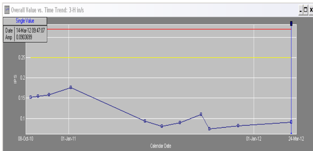
Figura 4.13. Comportamiento “Overall Value” en función del tiempo de la bomba G-2005A.
