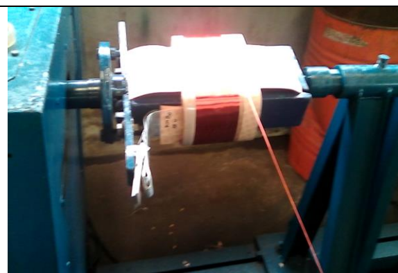
Ilustración 106 Proceso de fabricación de devanado de alta Tensión de un TX de 25 kVA, hecho en máquina bobinadora fabricada. Fuente: El autor.
