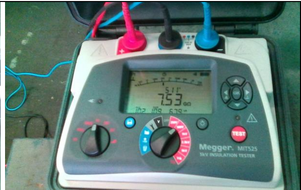
Ilustración 41 Medida de aislamiento de alta vs baja. Fuente: El autor.
