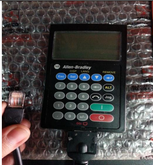
Ilustración 95 Pantalla de cristal líquido, 22-HIM-A3. Fuente: El autor.
