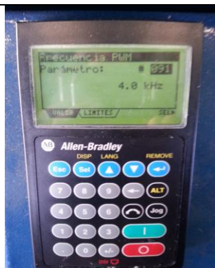
Ilustración 101 Programación de parámetro A091. Fuente: El autor.
