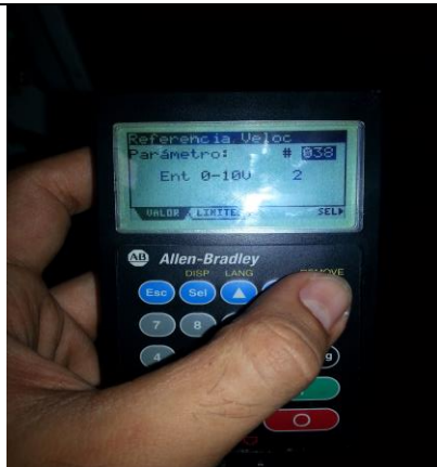
Ilustración 99 Programando parámetro P038. Fuente: El autor.
