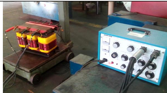
Ilustración 43 Prueba de Relación de transformación. Fuente: El autor.
