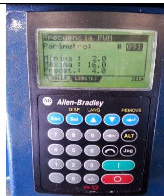
Ilustración 102 Opciones de programación del parámetro A091. Fuente: El autor.
