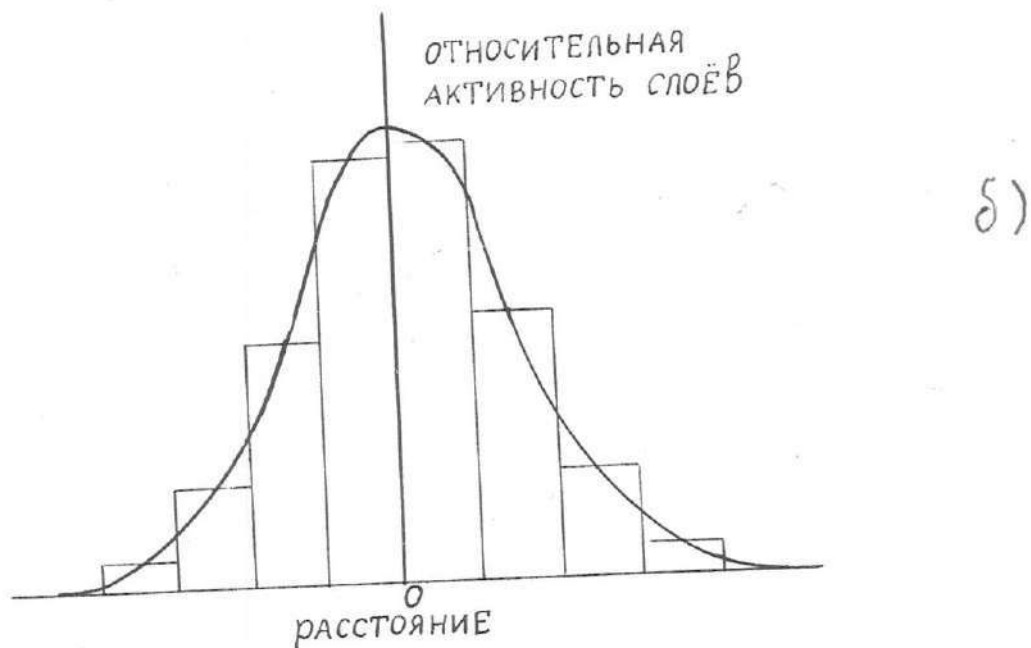
Рис. 3.2. Схема, характеризующая расположение линии вношения радиоактивного индикатора в ориентированные слои Na -монтмориллонита и их деление при анализе (а), а также пример распределения относительной активности по слоям (б)
